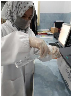
Gambar 5. Dibaca dengan spektrofotoneter dengan \lambda 425nm
