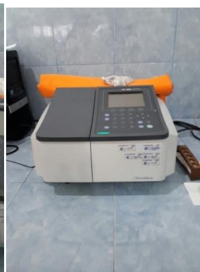
Gambar 5. Dibaca dengan spektrofotoneter dengan \lambda 425nm
