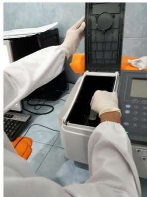
Gambar 5. Dibaca dengan spektrofotoneter dengan \lambda 425nm
