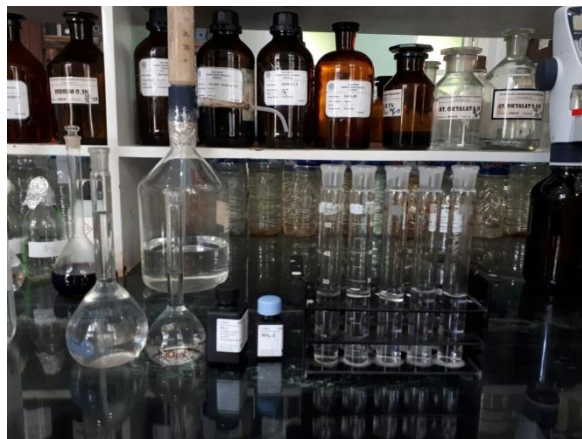
Gambar 2 meng add kan 250ml larutan ke labu ukur dan 25ml ke tabung nessler
