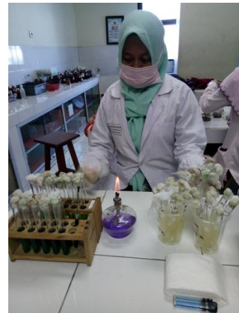
Pemeriksaan total bakteri koliform pada air sawah sebelum dan sesudah filtrasi
