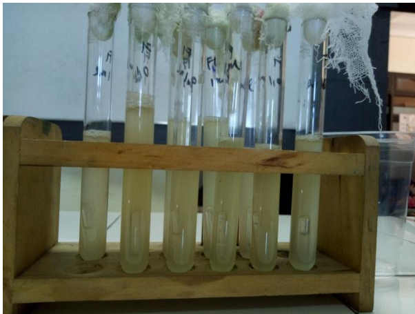
Pemeriksaan total bakteri koliform pada air sawah sebelum dan sesudah filtrasi
