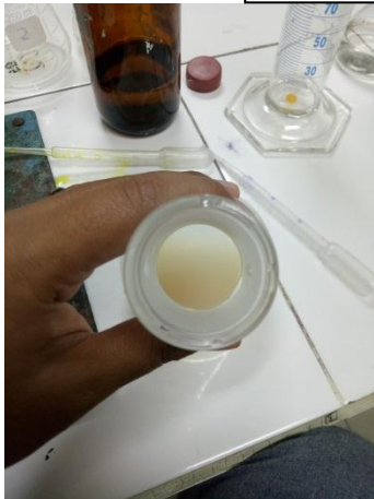
Pemeriksaan kadar klorida pada air sawah sebelum dan sesudah filtrasi
