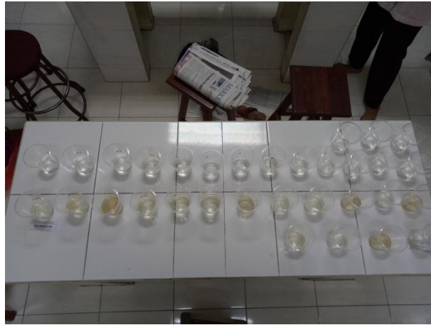
Analisa fisik air sawah sebelum dan sesudah filtrasi
