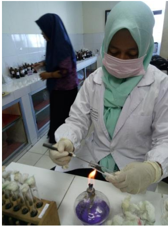
Pemeriksaan total bakteri koliform pada air sawah sebelum dan sesudah filtrasi
