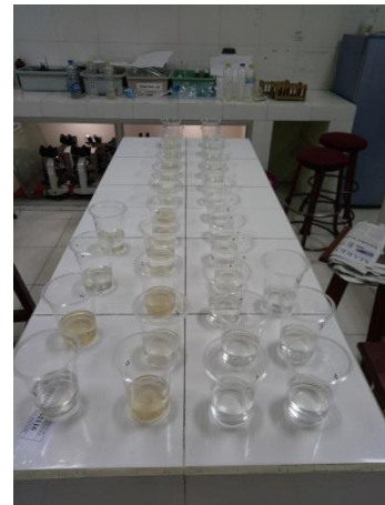
Analisa fisik air sawah sebelum dan sesudah filtrasi
