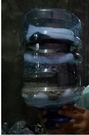
Susunan Media Filtrasi Air Sawah
