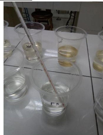
Pemeriksaan suhu pada air sawah sebelum dan sesudah filtrasi
