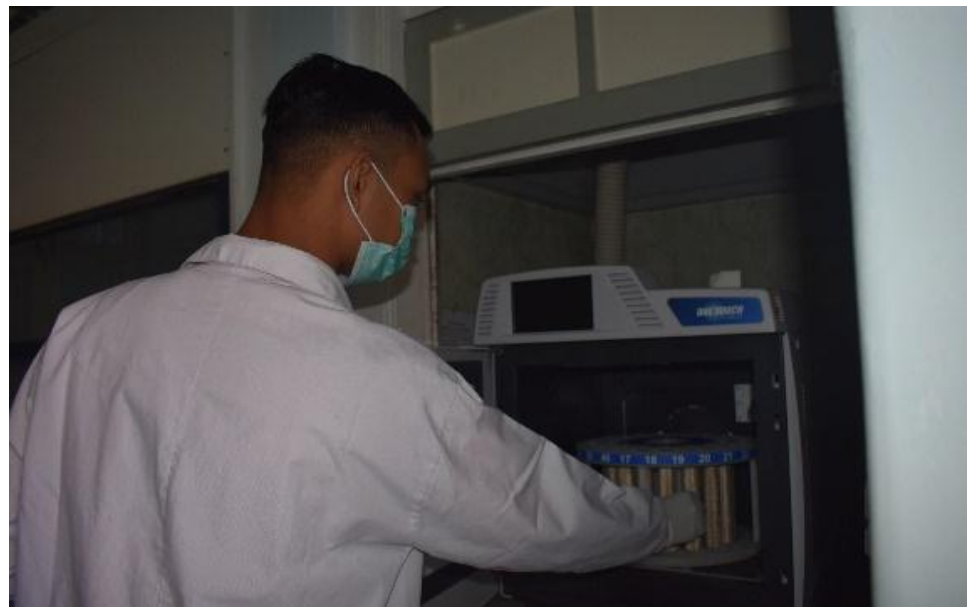
Gambar 6. Memasukkan sampel ke dalam alat destruksi
