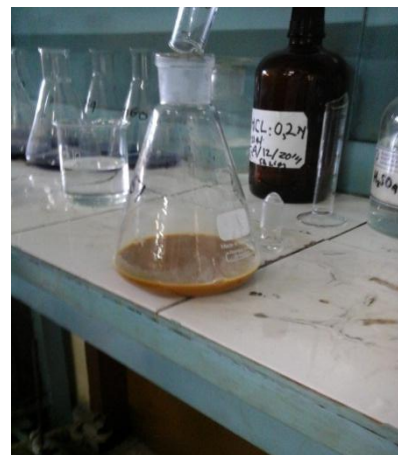
Hasil yang sudah di reflux di dinginkan dan di tambah HCL
