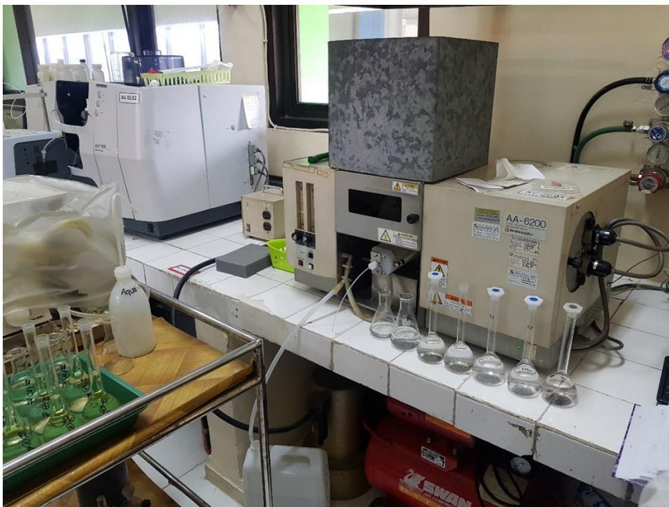
Gambar 8. Alat spektrofotometer serapan atom (SSA)
