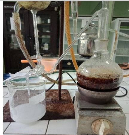
Tahap 4 Proses pemanasan dan penampungan minyak cengkeh
