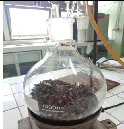
Tahap 2 Memasukkan cengkeh ke dalam labu destilasi
