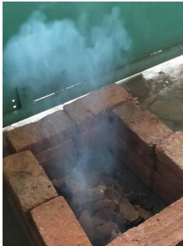
**Gambar 3.4 Proses Pengarangan**
