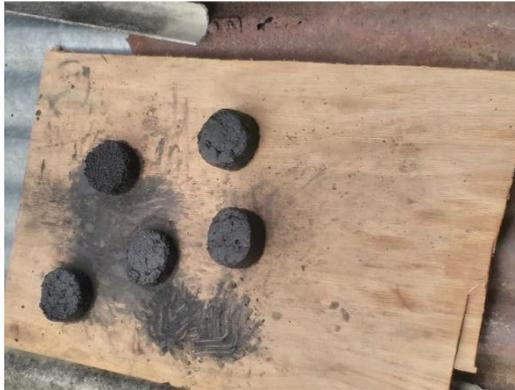
**Gambar 3.7 Proses pencetakan briket**
