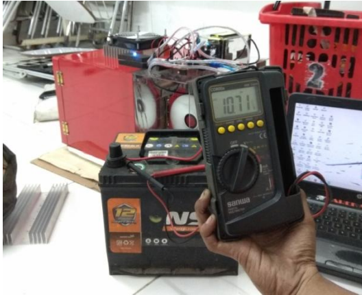
Gambar 4.11 Pengujian Cooling Box dengan Batterai / Accu
