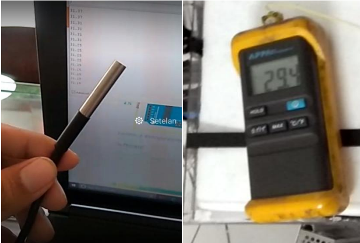
Gambar 4.10 Pengujian sensor dengan Thermometer
