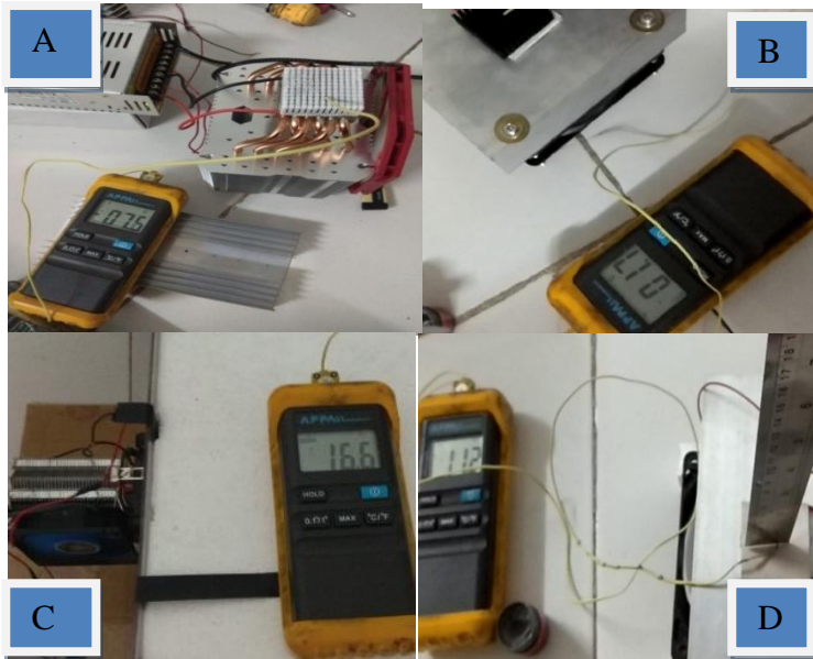
Gambar 4.9 Pengujian Heatsink dan Peltier
