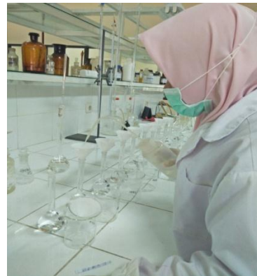
Sampel Disaring dengan kertas whatman no. 40 dan di encerkan Aquades
