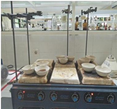
Sampel di panaskan dengan Hotplatedan di lanjutkan dengan
