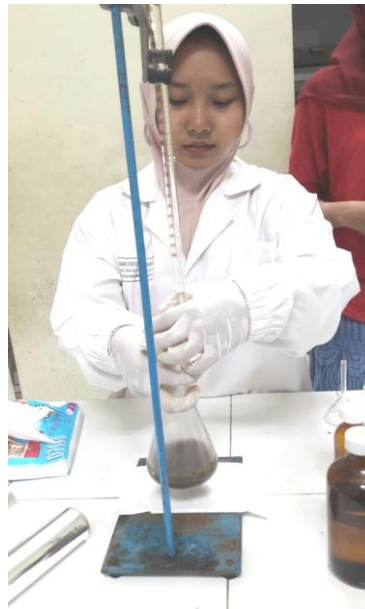
b. Proses titrasi sampel minyak jelantah
