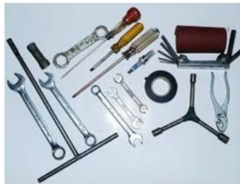
Gambar 3.6 Kunci untuk merakit komponen alat uji rem cakram (sumber: Laboratorium Universitas Muhammadiyah Surabaya)
