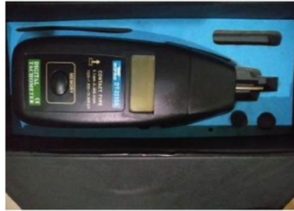
Gambar 3.5 Alat penguji kecepatan rotasi ( sumber: Laboratorium Universitas Muhammadiyah Surabaya)
