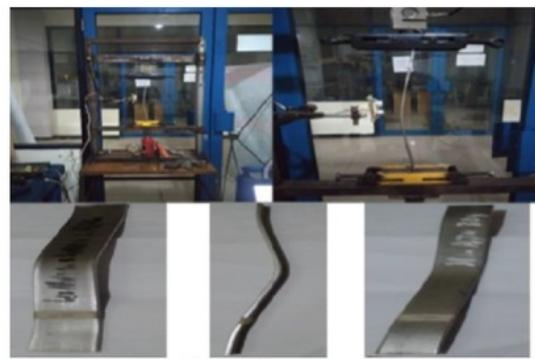
Gambar 16. Pengujian AUBP Dengan *specimen* plat strip ASTM 304 Panjang 30 cm, 38 cm, 44 cm lebar 20 x 4 mm. Sumber: Pribadi (2019)
