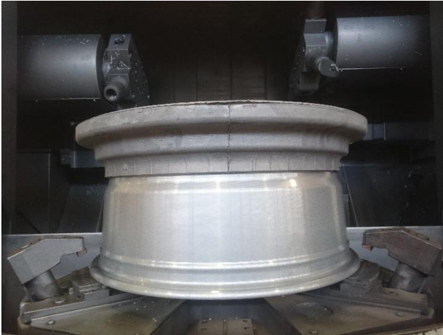
Gambar 2.8 Chuck dalam kondisi membuka
