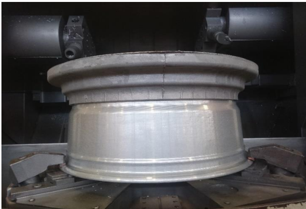
Gambar 2.9 Chuck dalam kondisi menutup
