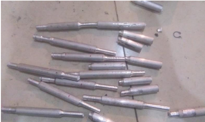
Gambar 5. Patahnya material uji.
