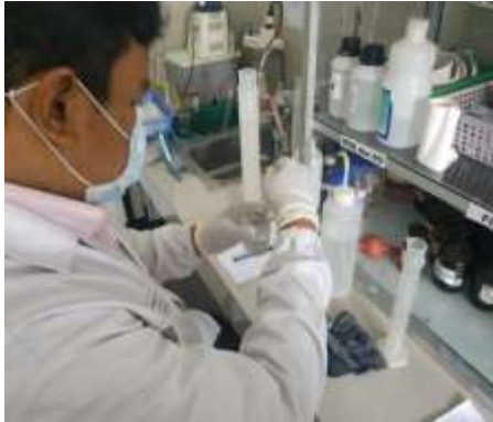
Larutkan 1 gram asam sulfanilat dalam 100 ml asam asetat 30 %
