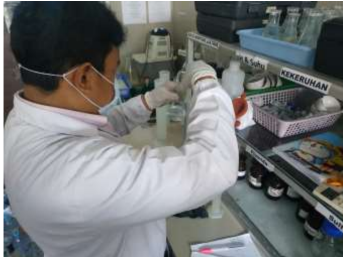
Ambil 50 ml larutan I, lalu campurkan dengan 50 ml larutan II Lalu masukkan dalam wadah coklat
