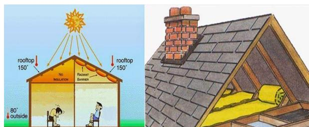
Gambar 3. Perbedaan Lapisan Atap Antara menggunakan insulator dan yang Tidak menggunakan insulator
