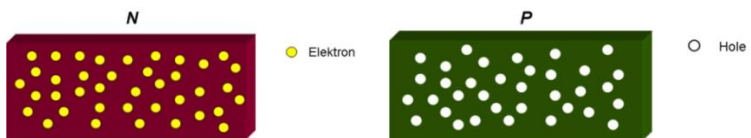
Gambar 2.2 Semikonduktor P dan N sebelum disambung
