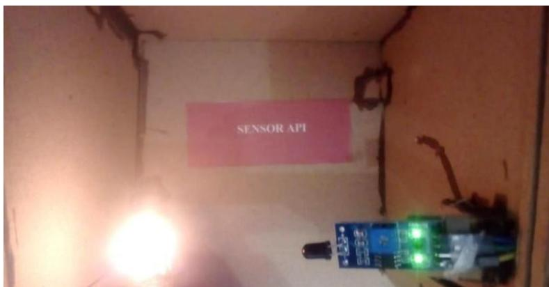
**Gambar 4.14** Pengujian Sensor api
