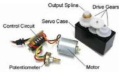
Gambar 4. Bentuk Servo Motor [11]
