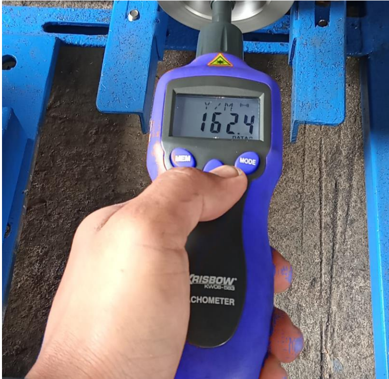
Gambar 4. 4 Pengukuran pada motor induksi
