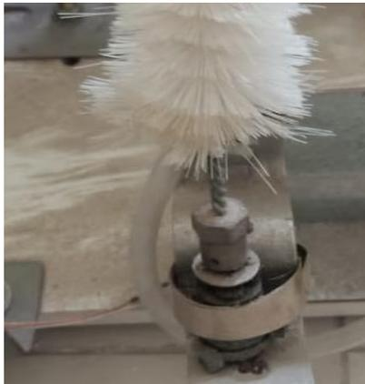
**Gambar 4.4** Motor Penggerak Sikat Yang Digunakan Dalam Penelitian.
