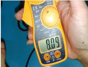
Gambar 4. 16 Pengukuran Arus pada Mesin Otomatis
