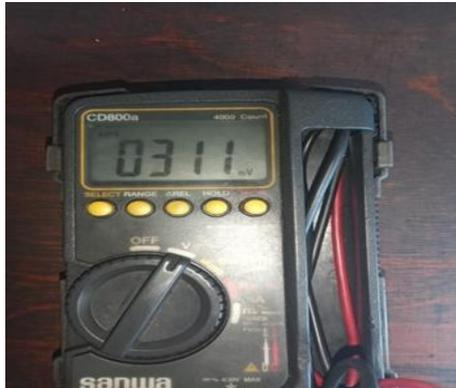
Gambar 4. 7 Pengukuran Tegangan Thermistor
