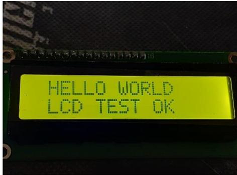
Gambar 4. 11 Hasil Pengujian LCD Karakter 16X2
