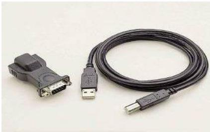
Gambar 3.6 Konverter Serial To Usb
