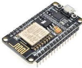
Gambar 2. 15 NodeMCU
