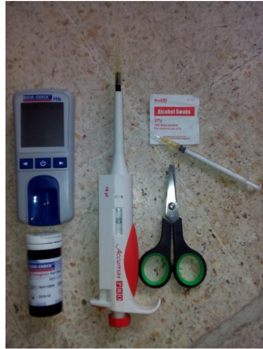
Gambar.2 Alat Pemeriksaan (Mikropipet, Yellow tip, Hb Check dan Strip, Gunting, Sonde, Alkohol Swab)
