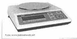
Alat timbang ini untuk mengukur berat benda yang lebih kecil seperti emas berupa cinci, gelang, kalung atau anting
