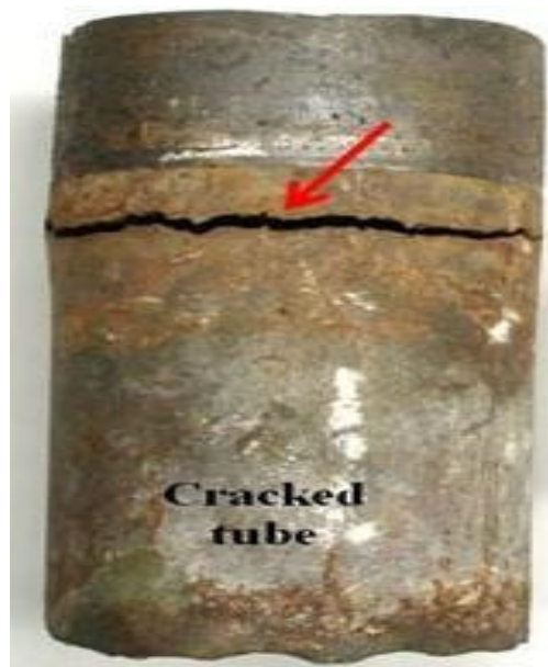
Gambar 2.19 Korosi retak pada pipa (Sumber : Korosi, Kenneth r. Trethewey, 1991)
