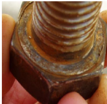
Gambar 2.12 Crevice corrosion pada baut
