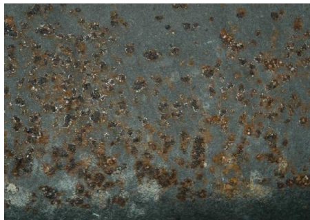
Gambar 2.13 Korosi sumuran pada bak mandi
