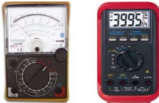
Gambar 2.20 Multimeter Analog dan Multimeter Digital
