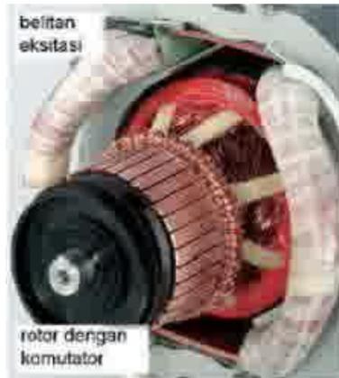
Gambar 2.11. Komutator pada motor universal.
