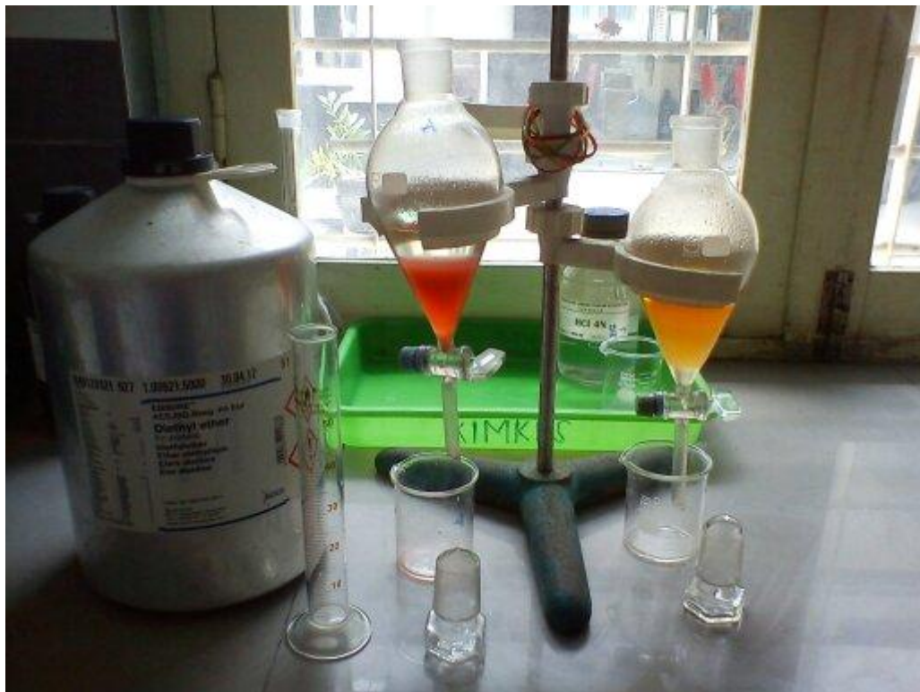
Proses Ekstraksi dengan menggunakan corong pisah
