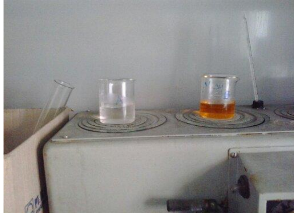
Proses penguapan dengan menggunakan Waterbath
