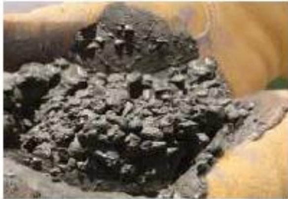
Gambar 2.1 Campuran Beton Kelebihan Air
