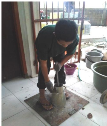
Gambar 3.6 Proses Perojokan Slump Test
