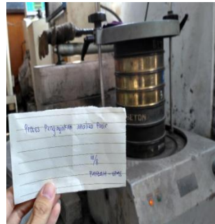
Proses Pengayaan Analisis Agregat Halus (Pasir)
