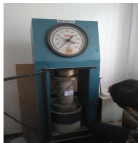
Proses Tes Tekan Beton (di Laboratorium Tek. Beton Universitas Narotama Surabaya)
