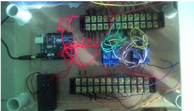
**Gambar 3.10** rangkaian kontrol jembatan otomatis
