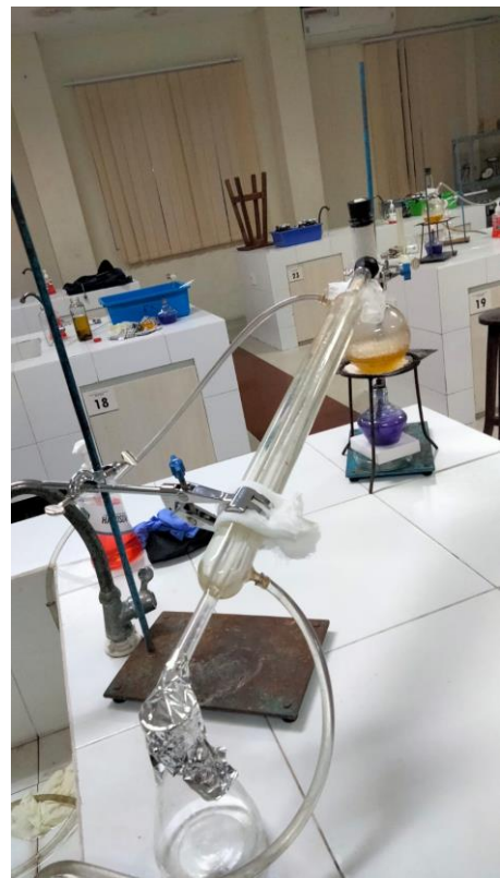
e. (proses destilasi sampel)
