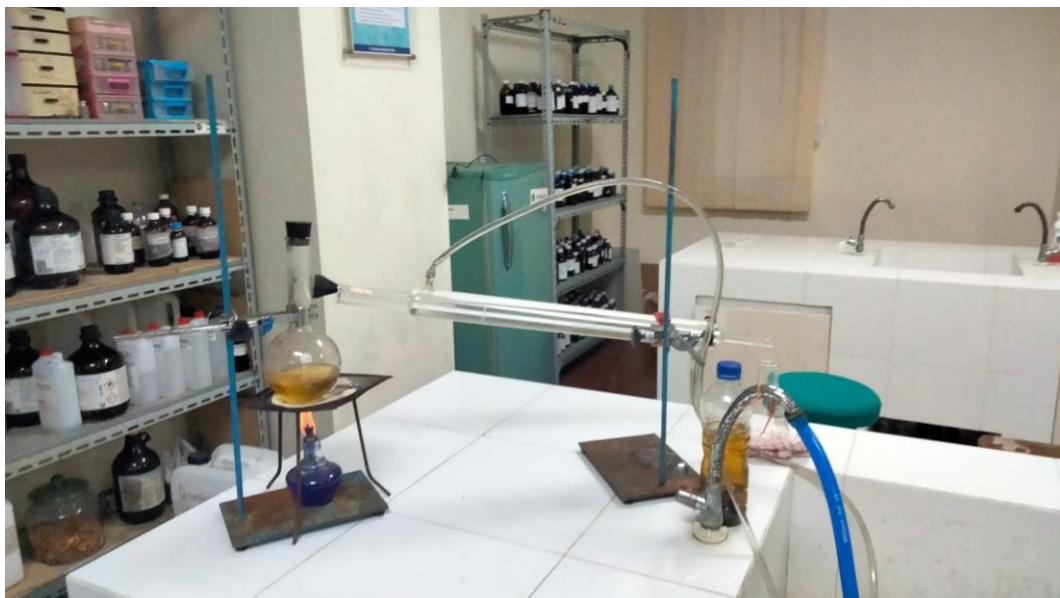
h. (proses destilasi sampel)
