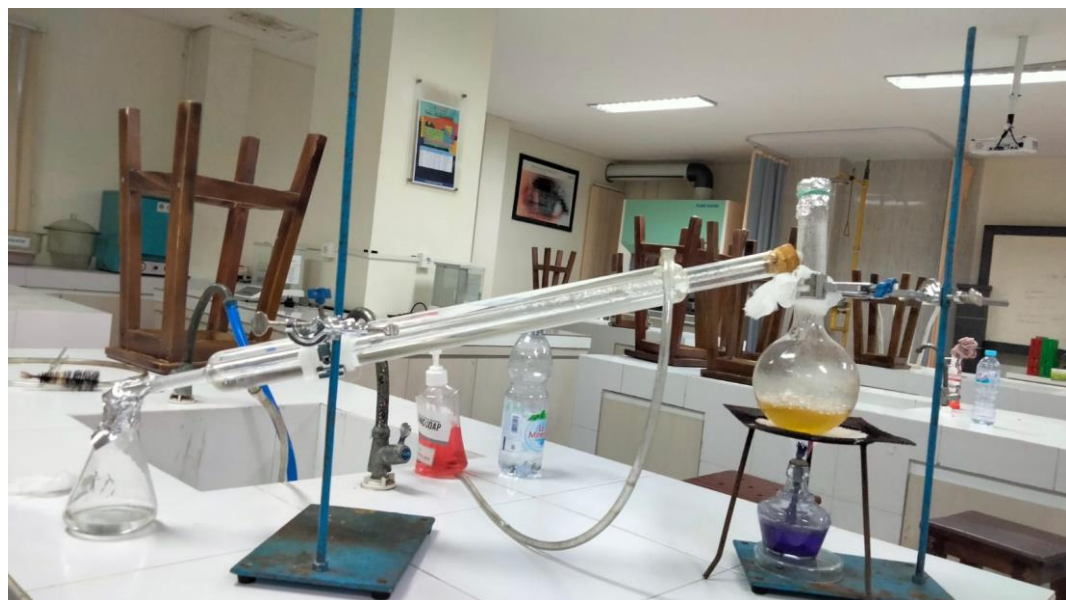
f. (proses destilasi sampel)
