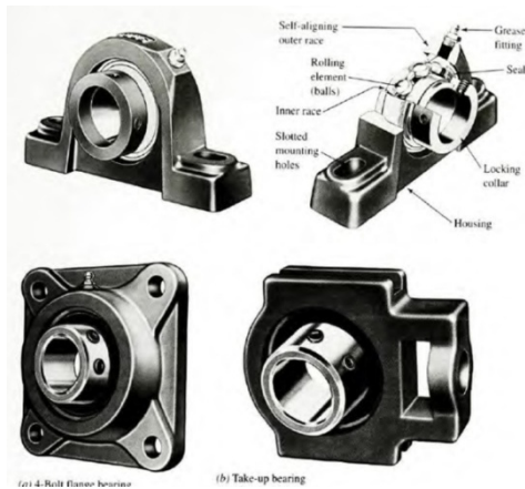
Gambar 2.14. Blok alas bantalan bola dan bantalan bercangkang
