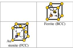
Gambar 2 Struktur Kristal Duplex Sifat-sifat mekanik dan komposisi kimia material DSS 2205 dan HSS VL D36 dapat dilihat pada tabel di bawah ini (5,8)
