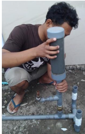
Gambar 4.1 Proses Perakitan Pompa Hidram Doble Power Sumber : Dokumentasi Pribadi
