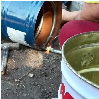
Proses Pembuatan Alur Spiral
