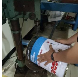
Proses Pelubangan Lubang Pipa Pada Bak Air
