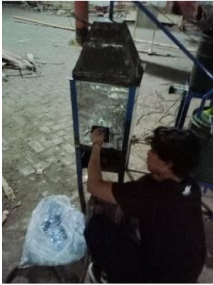
Proses Memasukkan Sampah Plastik Ke Reaktor Pembakaran
