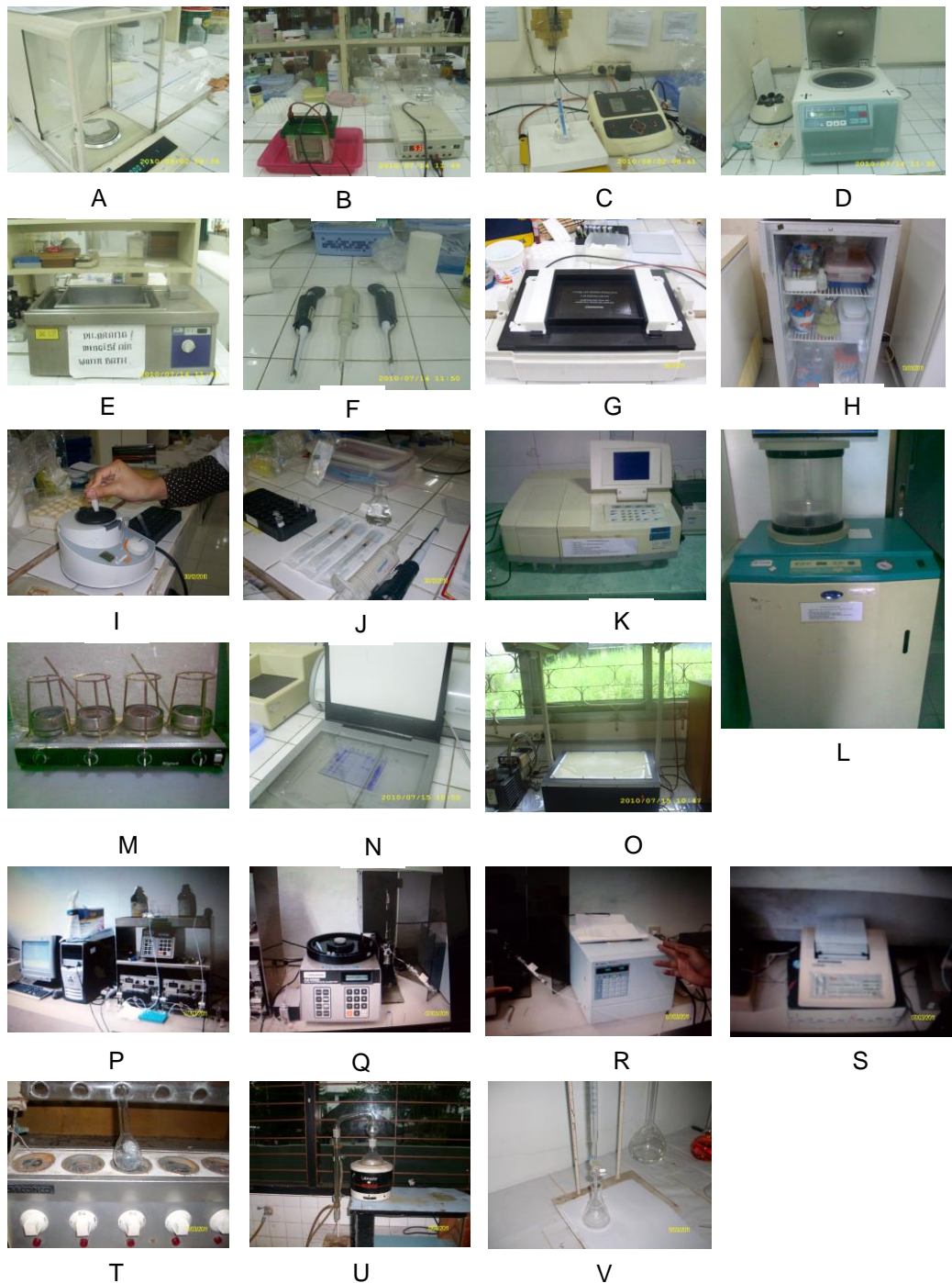
Gambar XI.5 Alat-alat Laboratorium Penelitian. A. Timbangan analitik; B. Elektroforesis; C. pH Meter dan Stirer; D. Sentrifus; E. Shaker; F. Pipet Volumetri; G. Trans Blot; H. Refrigerator; I. Stirer; J. Sruit/Syringe; K. Spektrofotometer UV; L. Vacum Freez; M. Destruktor; N. Scanner; O. Penerawang hasil scan Gel; P.Q.R.S. Perangkat HPLC; T, U, V. Perangkat Uji Protein Total.
