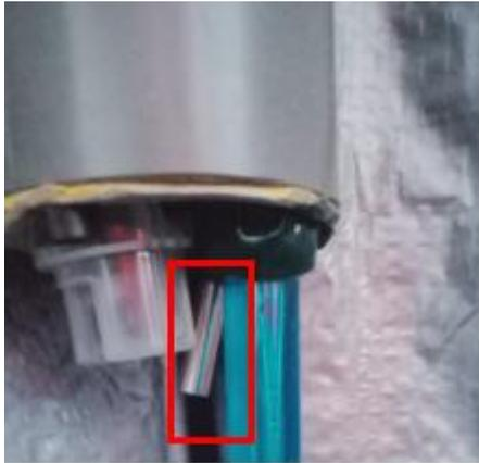
Gambar 4. 16 Sensor Suhu pada Air Kolam Ikan
