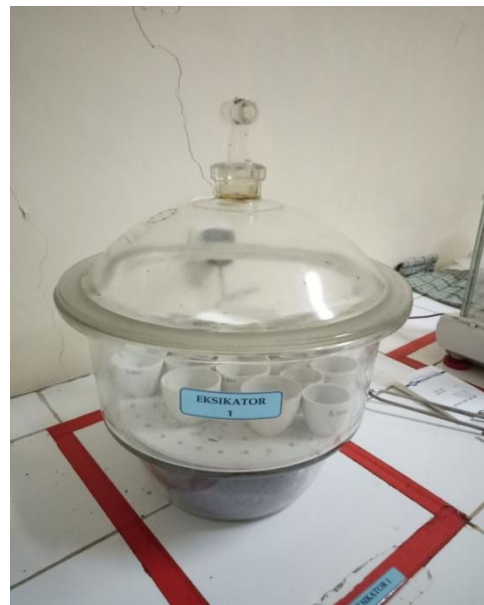
Gambar 8 : Proses pendinginan menggunakan eksikator
