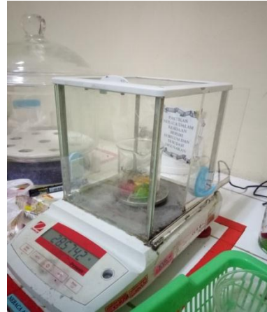
Gambar 2 : Proses penimbangan sampel jelly
