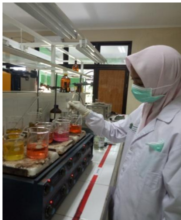
Gambar 3 : Proses pemanasan jelly menggunakan hot plate
