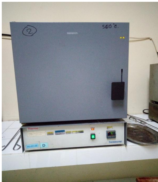
Gambar 7 : Proses pengabuan menggunakan furnace
