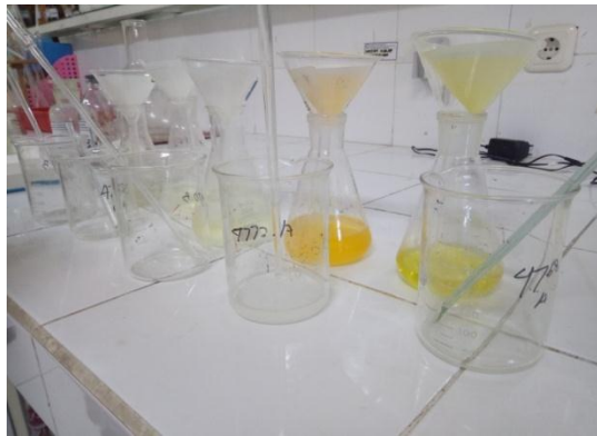
Gambar 5 : Proses penyaringan endapan siklamat
