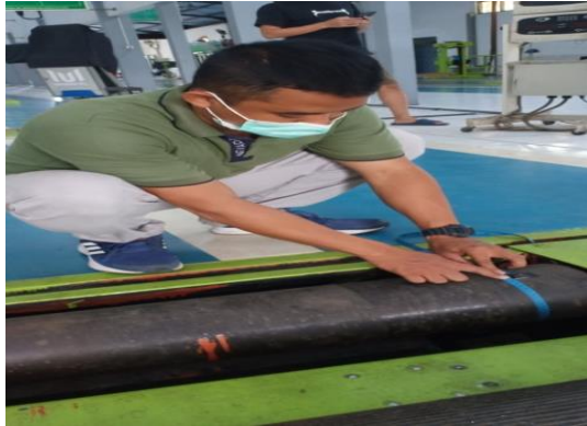
Gambar 4 5 Mengukur Keliling Roller
