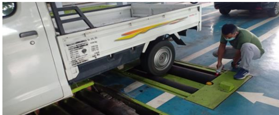
Gambar 4 1 Proses Uji Speedometer Kendaraan
