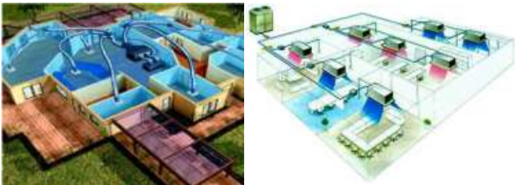
Gambar 2.1 proses pendinginan ruangan dengan AC sentral
