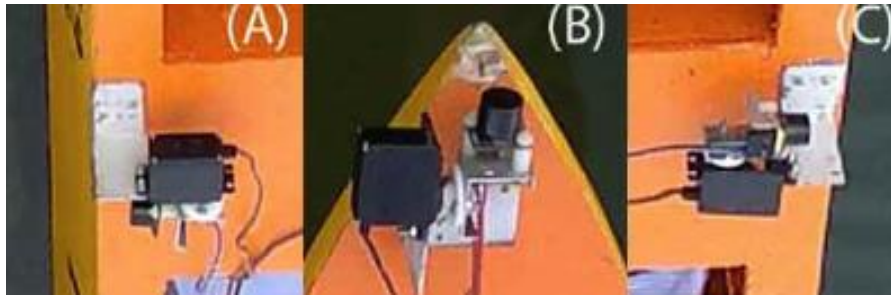
Gambar 18 (a) Sensor sonar bagian kiri kapal (b) Sensor sonar bagian depan kapal (c) Sensor sonar bagian kanan kapal
