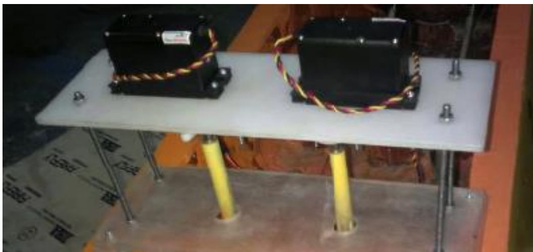
Gambar 19 Motor servo sebagai penggerak rudder
