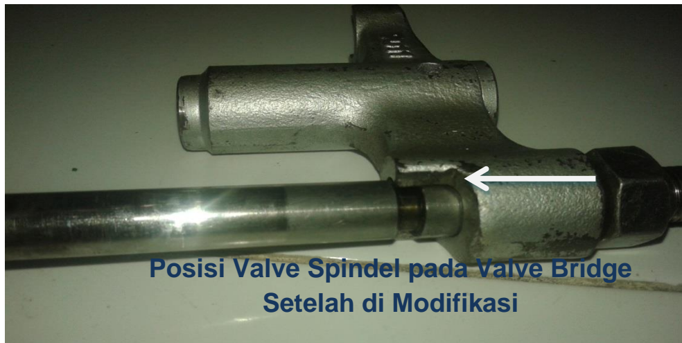
Gambar 4.16 Valve Bridge setelah di Modifikasi
