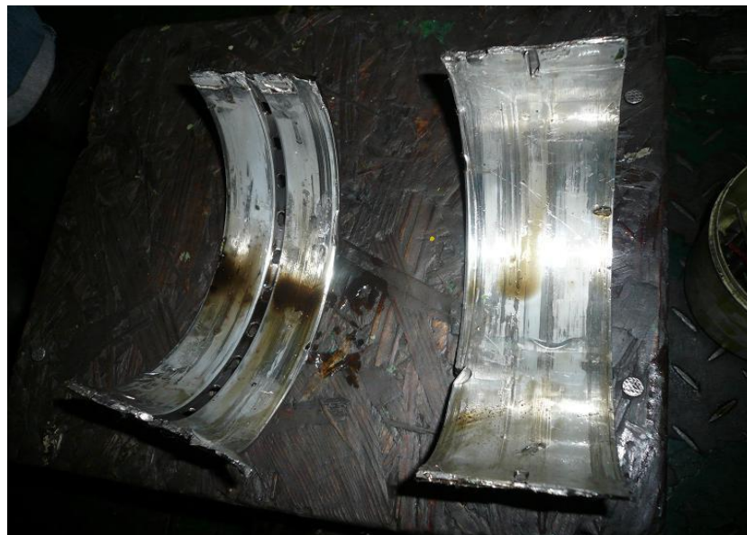
Gambar 4.6 kerusakan yang terjadi pada Crank Pin Bearing
