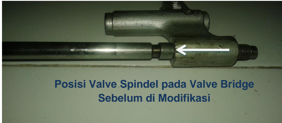
Gambar 4.15 Valve Bridge sebelum di Modifikasi
