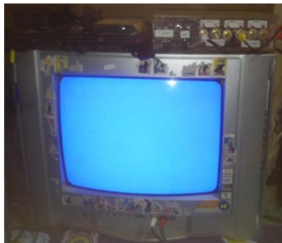
Gambar 4.10 Televisi mengalami blue screen karena kesalahan pemasangan pada switch timer
