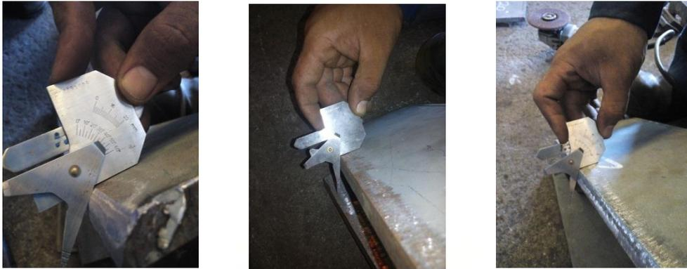
Gambar 4.2. Pengukuran/Pembuatan Bevel
