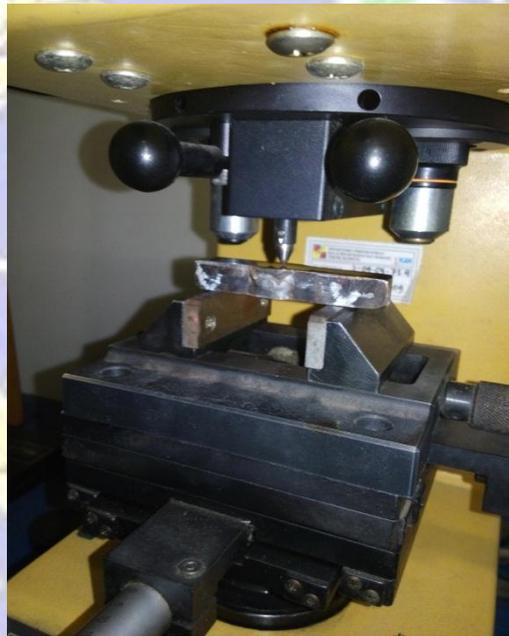
Gambar 4.14. Cara Meletakkan Test Pieces pada Mesin Uji Kekerasan
