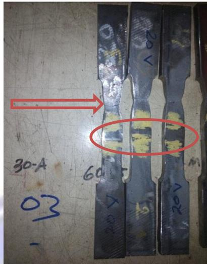
Gambar 4.12. Tests Piece Setelah Patah
