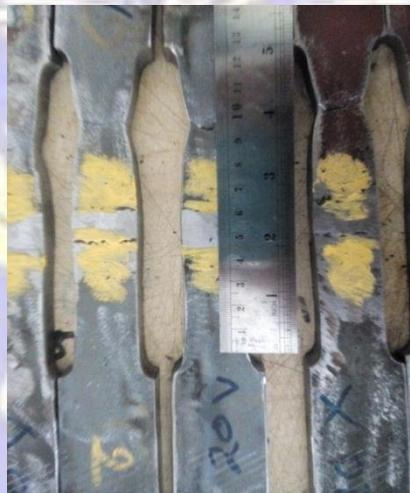
Gambar 4.13. Pengukuran Panjang Setelah Patah ( $L_1$ ) mm
