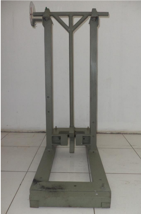
Gambar 2.2 Kerangka alat uji dimensi 1000 x 600 x 965 mm
