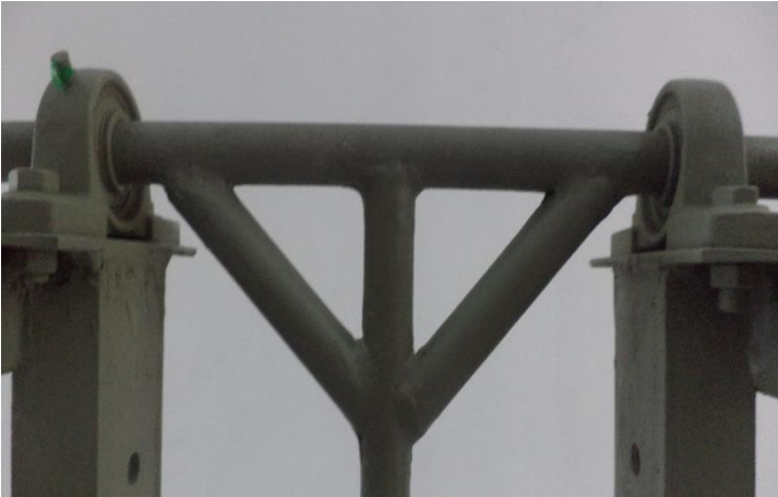
Gambar 2.4 Poros pengayun \varnothing 25 \times 500 .
