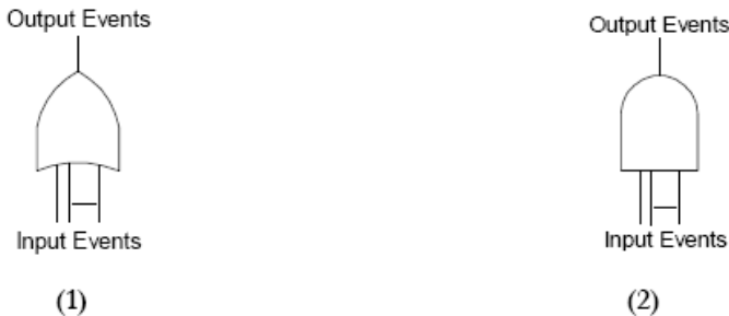
Gambar3.2 Dua symbol yang biasa digunakan dalam pohon kegagalan gerbang: (1) gerbang OR, (2) gerbang AND.
